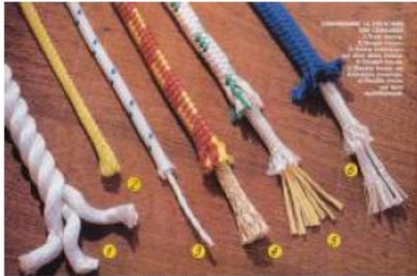
Différents types de cordages : 1- trois torons 2- simple tresse 3- tresse extérieure 4- double tresse 5- double tresse sur faisceaux toronnés 6- double tresse sur âme multifilament.
